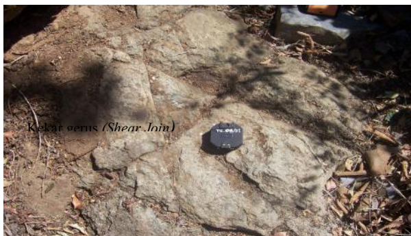
Foto 7. Kenampakkan kekar gerus ( Shear Joint ) pada intrusi batuan beku diorit (LP 51, arah kamera N 065° E).
